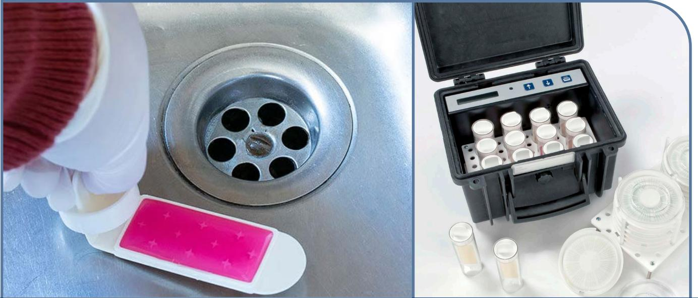
相关产品：Dipslide 测菌板、DI 10 测菌板恒温培养箱
